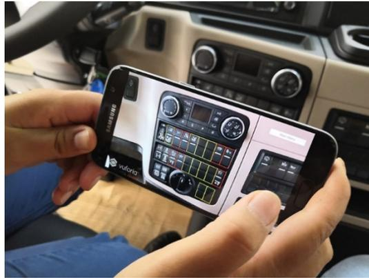
*Abbildung 25. Das System erkennt automatisch die Symbole der montierten Schalter und gibt MitarbeiterInnen Feedback zum aktuellen Status.*
