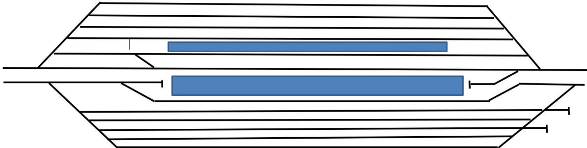
Abbildung 24: Gleisplan A-Bahnhof DT-Line (Referenz Bhf. Brenner, vereinfacht)
