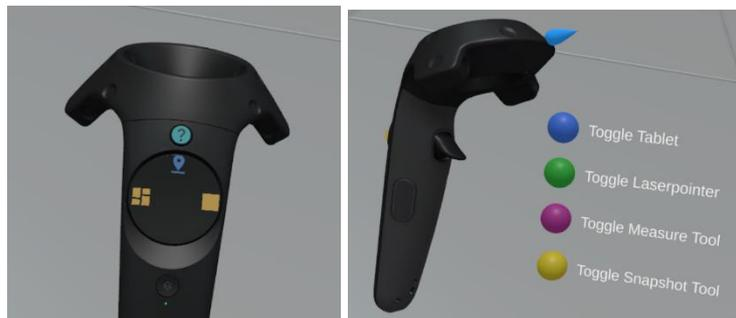
Abbildung 50. COLBERT Controller Belegung.
